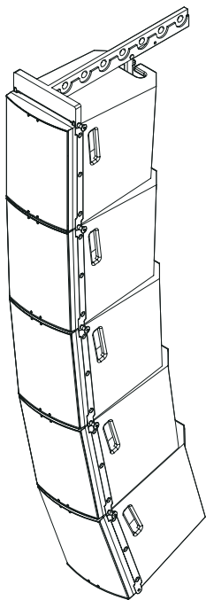
图45. 5只音箱组成的独立吊挂线阵列系统
